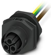
Wanddurchführung, für Steckverbinder, Anschlussart: Einzeladern, Polzahl: 2+PE, M25, Buchse, 450 V, 20 A, PA, schwarz, Kodierung: P, 2,5 mm<sup>2</sup>, Leitungslänge: 0,5 m
