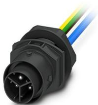
Wanddurchführung, für Steckverbinder, Anschlussart: Einzeladern, Polzahl: 2+PE, M20, Stift, 450 V, 20 A, PA, schwarz, Kodierung: P, 2,5 mm<sup>2</sup>, Leitungslänge: 0,5 m
