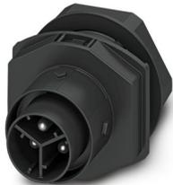
Wanddurchführung, für Steckverbinder, Anschlussart: Push-in-Anschluss, Polzahl: 2+PE, M25, Stift, 0,5 mm<sup>2</sup> ... 2,5 mm<sup>2</sup>, 500 V, 20 A, PA, schwarz, Kodierung: P
