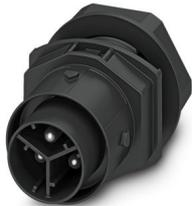
Wanddurchführung, für Steckverbinder, Anschlussart: Push-in-Anschluss, Polzahl: 2+PE, M20, Stift, 0,5 mm<sup>2</sup> ... 2,5 mm<sup>2</sup>, 500 V, 20 A, PA, schwarz, Kodierung: P
