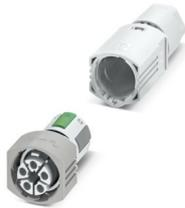
Steckverbinder, Anschlussart: Push-Lock-Anschluss, Polzahl: 4+PE, Buchse, 0,5 mm<sup>2</sup> ... 2,5 mm<sup>2</sup>, 600 V, 17,5 A, PA, lichtgrau, Kodierung: P, Leitungsaußendurchmesser: 7 mm ... 11 mm und 11 mm ... 16 mm
