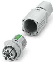
Steckverbinder, Anschlussart: Push-Lock-Anschluss, Polzahl: 4+PE, Buchse, 0,5 mm<sup>2</sup> ... 2,5 mm<sup>2</sup>, 600 V, 17,5 A, PA, lichtgrau, Kodierung: P, Leitungsaußendurchmesser: 7 mm ... 11 mm und 11 mm ... 16 mm
