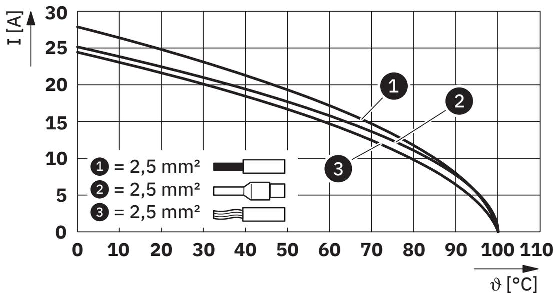
Derating-Diagramm für 2,5 mm<sup>2</sup>
