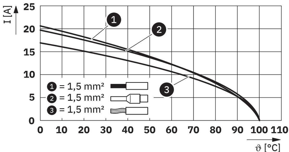
Derating-Diagramm für 1,5 mm<sup>2</sup>
