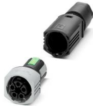
Steckverbinder, Anschlussart: Push-Lock-Anschluss, Polzahl: 4+PE, Buchse, 0,5 mm<sup>2</sup> ... 2,5 mm<sup>2</sup>, 600 V, 17,5 A, PA, schwarz, Kodierung: P, Leitungsaußendurchmesser: 7 mm ... 11 mm und 11 mm ... 16 mm
