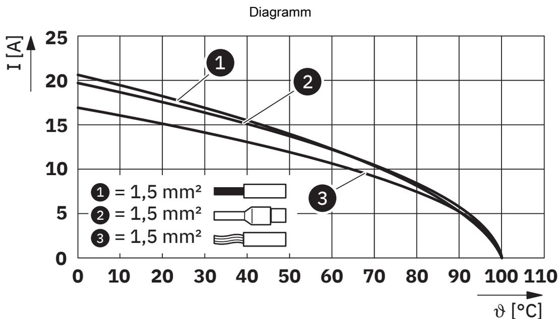
Derating-Diagramm für 1,5 mm<sup>2</sup>
