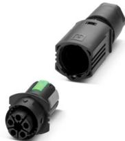
Steckverbinder, Anschlussart: Push-Lock-Anschluss, Polzahl: 4+PE, Buchse, 0,5 mm<sup>2</sup> ... 2,5 mm<sup>2</sup>, 600 V, 17,5 A, PA, schwarz, Kodierung: P, Leitungsaußendurchmesser: 7 mm ... 11 mm und 11 mm ... 16 mm
