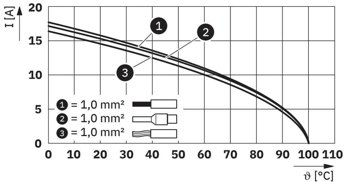
Derating-Diagramm für 1,0 mm<sup>2</sup>
