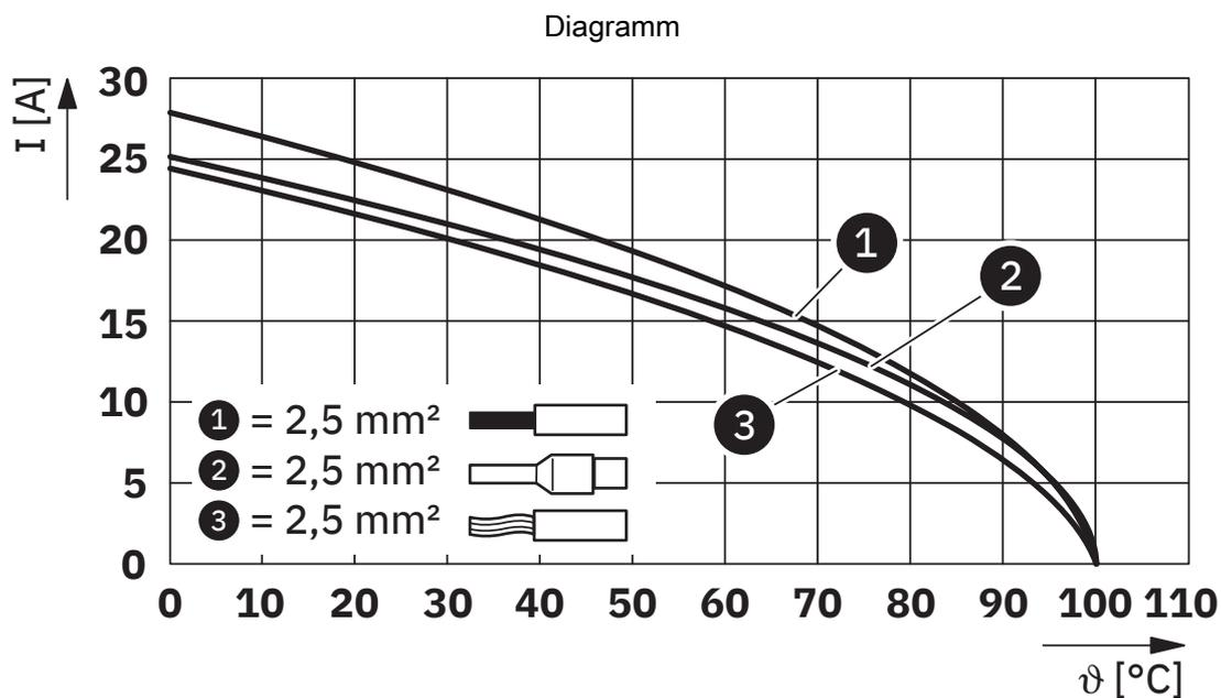
Derating-Diagramm für 2,5 mm<sup>2</sup>
