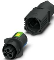
Steckverbinder, Anschlussart: Push-Lock-Anschluss, Polzahl: 2+PE, Buchse, 0,5 mm<sup>2</sup> ... 2,5 mm<sup>2</sup>, 500 V, 20 A, PA, schwarz, Kodierung: P, Leitungsaußendurchmesser: 6 mm ... 9 mm und 8 mm ... 13 mm
