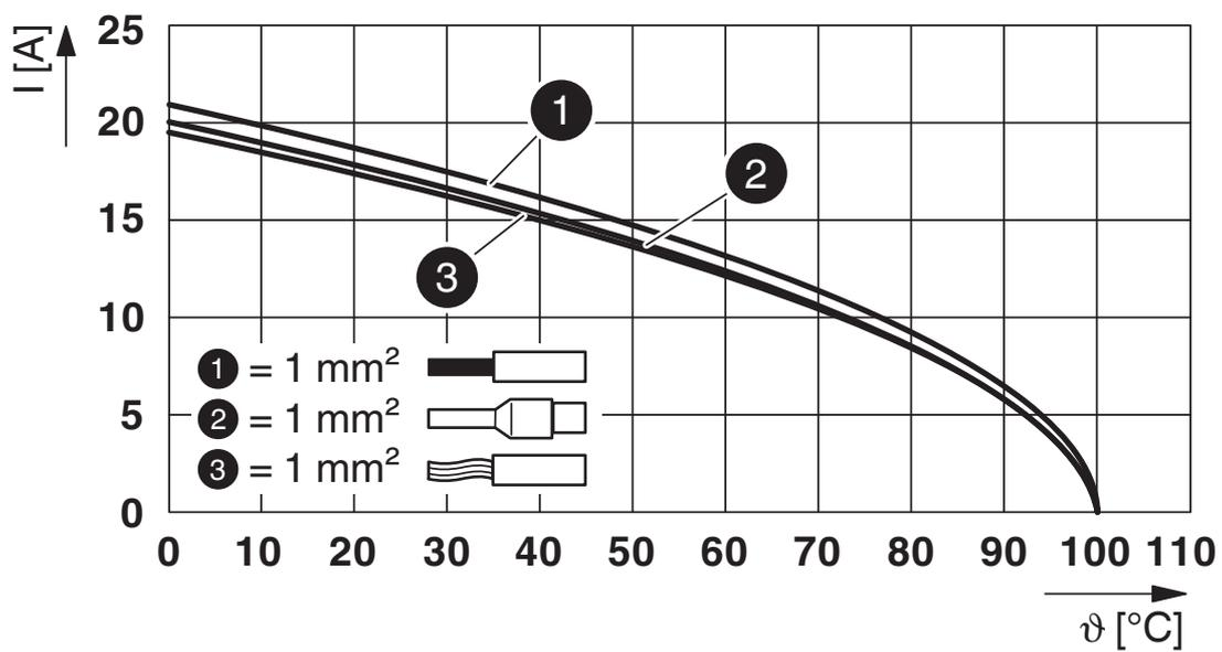
Derating-Diagramm für 1,0 mm<sup>2</sup>
