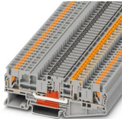
Messertrennklemme, für Überspannungsschutz CLIXTRAB, Prüftrennklemme für Überspannungsschutz, Nennspannung: 400 V, Nennstrom: 20 A, Anschlussart: Push-in-Anschluss, Bemessungsquerschnitt: 2,5 mm<sup>2</sup>, Querschnitt: 0,14 mm<sup>2</sup> - 4 mm<sup>2</sup>, Montage: NS 35/7,5, NS 35/15, Farbe: grau
