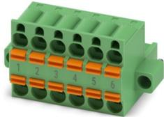
Leiterplatten-TWIN-Stecker, Nennquerschnitt: 2,5 mm<sup>2</sup>, Farbe: grün, Nennstrom: 12 A, Bemessungsspannung (III/2): 320 V, Kontaktoberfläche: Au, Kontaktart: Buchse, Anzahl der Reihen: 1, Polzahl: 6, Artikelfamilie: TFKC 2,5/..-STF, Rastermaß: 5,08 mm, Anschlussart: Push-in-Federanschluss, Anschlussrichtung Leiter/Platine: 0 °, Rasthaken: - Rasthaken, Stecksystem: COMBICON MSTB 2,5, Verriegelung: Schraubverriegelung, Befestigungsart: Schraubflansch, Verpackungsart: verpackt im Karton
