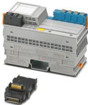
Axioline F, Analogausgabemodul, Analoge Ausgänge: 4 (HART), 0 mA ... 20 mA, 4 mA ... 20 mA, Anschlussstechnik: 2-Leiter, Übertragungsgeschwindigkeit im Lokalbus: 100 MBit/s, Extreme Conditions-Variante, eigensicher, HART-Funktionalität, Schutzart: IP20, inklusive Bussockelmodul und Axioline F-Steckern
