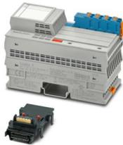
Axioline P, Digitalausgabemodul, Digitale Ausgänge: 4, 24 V DC, 48 mA, Anschlusstechnik: 2-Leiter, Magnetansteuerung, eigensicher, Übertragungsgeschwindigkeit im Lokalbus: 100 MBit/s, Schutzart: IP20, inklusive Bussockelmodul und Stecker
