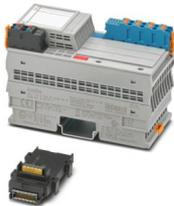
Axioline F, Digitalausgabemodul, Digitale Ausgänge: 4, 21 V, Anschlusstechnik: 2-Leiter, Magnetansteuerung, Extreme Conditions-Variante, eigensicher, Übertragungsgeschwindigkeit im Lokalbus: 100 MBit/s, Schutzart: IP20, inklusive Bussockelmodul und Axioline F-Steckern
