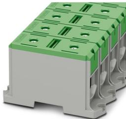
Hochstromklemme, Nennspannung: 1000 V, Nennstrom: 380 A, Anzahl der Anschlüsse: 2, Polzahl: 1, Anschlussart: Schraubanschluss, Bemessungsquerschnitt: 240 mm<sup>2</sup>, Querschnitt: 35 mm<sup>2</sup> - 240 mm<sup>2</sup>, Bemessungsquerschnitt: 240 mm<sup>2</sup>, Querschnitt: 35 mm<sup>2</sup> - 240 mm<sup>2</sup>, Montageart: Schraubmontage, Farbe: grün
