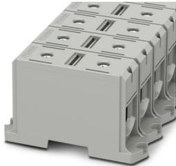
Hochstromklemme, Nennspannung: 1000 V, Nennstrom: 380 A, Anzahl der Anschlüsse: 2, Polzahl: 1, Anschlussart: Schraubanschluss, Bemessungsquerschnitt: 240 mm<sup>2</sup>, Querschnitt: 35 mm<sup>2</sup> - 240 mm<sup>2</sup>, Bemessungsquerschnitt: 240 mm<sup>2</sup>, Querschnitt: 35 mm<sup>2</sup> - 240 mm<sup>2</sup>, Montageart: Schraubmontage, Farbe: grau
