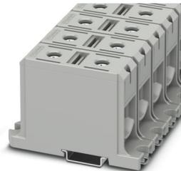
Hochstromklemme, Nennspannung: 1000 V, Nennstrom: 290 A, Anzahl der Anschlüsse: 2, Polzahl: 1, Anschlussart: Schraubanschluss, Bemessungsquerschnitt: 150 mm<sup>2</sup>, Querschnitt: 35 mm<sup>2</sup> - 150 mm<sup>2</sup>, Bemessungsquerschnitt: 150 mm<sup>2</sup>, Querschnitt: 35 mm<sup>2</sup> - 150 mm<sup>2</sup>, Montageart: NS 35/15, NS 35/7,5, Farbe: grau
