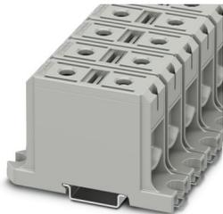
Hochstromklemme, Nennspannung: 1000 V, Nennstrom: 220 A, Anzahl der Anschlüsse: 2, Polzahl: 1, Anschlussart: Schraubanschluss, Bemessungsquerschnitt: 95 mm<sup>2</sup>, Querschnitt: 16 mm<sup>2</sup> - 95 mm<sup>2</sup>, Bemessungsquerschnitt: 95 mm<sup>2</sup>, Querschnitt: 16 mm<sup>2</sup> - 95 mm<sup>2</sup>, Montageart: NS 35/15, NS 35/7,5, Farbe: grau
