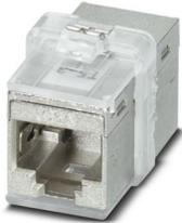
RJ45-Kupplung, Schutzart: IP20, Polzahl: 8, 10 GBit/s, CAT6<sub>A</sub>, Material: Metall, Anschlussart: Kupplung, Kabelabgang: gerade, Keystone Ausführung zur Verwendung mit IP20- und IP67-Anbaurahmen oder direkten Integration in die Gehäusewand, Ethernet
