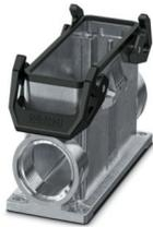
Sockelgehäuse B24, mit Querbügel, Material: Aluminiumdruckguss, seewasserbeständig, Kabelabgänge: 2, seitlich, 2x M32, Höhe: 84,7 mm, Kabelverschraubung: ohne, Standard
