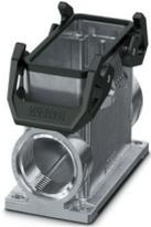
Sockelgehäuse B16, mit Querbügel, Material: Aluminiumdruckguss, seewasserbeständig, Kabelabgänge: 2, seitlich, 2x M40, Höhe: 84,7 mm, Kabelverschraubung: ohne, Standard
