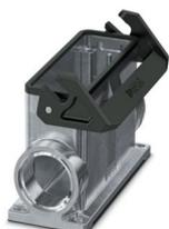
Sockelgehäuse B24, mit Längsbügel, Material: Aluminiumdruckguss, seewasserbeständig, Kabelabgänge: 2, seitlich, 2x M40, Höhe: 84,7 mm, Kabelverschraubung: ohne, Standard
