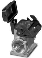
Sockelgehäuse B10, mit Längsbügel, Material: Aluminiumdruckguss, seewasserbeständig, Material Schutzdeckel: PC, Kabelabgänge: 2, seitlich, 2x M25, Höhe: 74,5 mm, Kabelverschraubung: ohne, Schutzdeckel: ja, Standard
