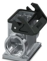
Sockelgehäuse B10, mit Längsbügel, Material: Aluminiumdruckguss, seewasserbeständig, Kabelabgänge: 2, seitlich, 2x M25, Höhe: 74,5 mm, Kabelverschraubung: ohne, Standard
