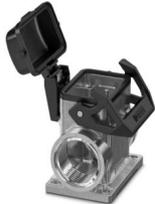
Sockelgehäuse B6, mit Längsbügel, Material: Aluminiumdruckguss, seewasserbeständig, Material Schutzdeckel: PC, Kabelabgänge: 2, seitlich, 2x M32, Höhe: 74,8 mm, Kabelverschraubung: ohne, Schutzdeckel: ja, Standard
