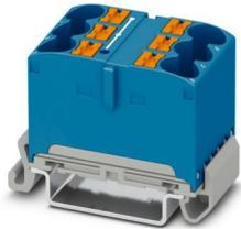
Verteilerblock, Block mit waagerechter Ausrichtung, Nennspannung: 800 V, Nennstrom: 57 A, Anzahl der Anschlüsse: 6, Anschlussart: Push-in-Anschluss, Bemessungsquerschnitt: 10 mm<sup>2</sup>, Querschnitt: 0,5 mm<sup>2</sup> - 16 mm<sup>2</sup>, Montageart: NS 35/7,5, NS 35/15, Farbe: blau
