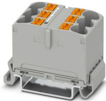
Verteilerblock, Block mit waagerechter Ausrichtung, Nennspannung: 800 V, Nennstrom: 57 A, Anzahl der Anschlüsse: 6, Anschlussart: Push-in-Anschluss, Bemessungsquerschnitt: 10 mm<sup>2</sup>, Querschnitt: 0,5 mm<sup>2</sup> - 16 mm<sup>2</sup>, Montageart: NS 35/7,5, NS 35/15, Farbe: grau
