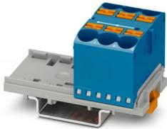
Verteilerblock, Block mit senkrechter Ausrichtung, Nennspannung: 800 V, Nennstrom: 57 A, Anzahl der Anschlüsse: 6, Anschlussart: Push-in-Anschluss, Bemessungsquerschnitt: 10 mm<sup>2</sup>, Querschnitt: 0,5 mm<sup>2</sup> - 16 mm<sup>2</sup>, Montageart: NS 35/7,5, NS 35/15, Farbe: blau
