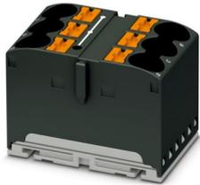
Verteilerblock, intern gebrückt, Nennspannung: 450 V, Nennstrom: 57 A, Anzahl der Anschlüsse: 6, Anschlussart: Push-in-Anschluss, Bemessungsquerschnitt: 10 mm<sup>2</sup>, Querschnitt: 0,5 mm<sup>2</sup> - 16 mm<sup>2</sup>, Montageart: aufrasten auf Tragschienenadapter, Direktmontage mit Flansch, Fliegend, Farbe: schwarz
