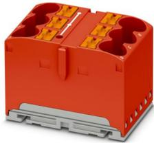
Verteilerblock, intern gebrückt, Nennspannung: 450 V, Nennstrom: 57 A, Anzahl der Anschlüsse: 6, Anschlussart: Push-in-Anschluss, Bemessungsquerschnitt: 10 mm<sup>2</sup>, Querschnitt: 0,5 mm<sup>2</sup> - 16 mm<sup>2</sup>, Montageart: aufrasten auf Tragschienenadapter, Direktmontage mit Flansch, Fliegend, Farbe: rot
