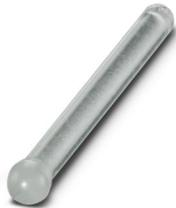
Lichtleiter vertikal 4 mm, transparent, mit Linsenkopf sphärisch 5,2 mm, Montage für Wandstärken ab 1 mm, aus Polycarbonat (UL 94-V0), Einbaulänge 45 mm, wasserdicht, IP68 (EN 50529)
