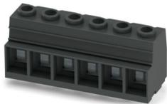
Leiterplattenklemme, Nennstrom: 125 A, Bemessungsspannung (III/2): 1000 V, Nennquerschnitt: 35 mm<sup>2</sup>, Anzahl der Reihen: 1, Polzahl pro Reihe: 6, Artikelfamilie: MKDSP 25, Rastermaß: 15 mm, Anschlussart: Schraubanschluss mit Zughülse, Schraubenangriffsform: Z2L Pozidriv mit Längsschlitz, Montage: Wellenlöten, Anschlussrichtung Leiter/Platine: 0 °, Farbe: schwarz, Pin-Layout: Lineares Pinning, Pinlänge [P]: 4,5 mm, Anzahl der Lötpins pro Potenzial: 4, Verpackungsart: verpackt im Karton
