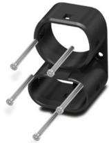
CHARX connect standard, CCS Typ 2, Reparatur-Kit, Zubehör, Gehäuse: schwarz, mit austauschbarem Steckgesichtrahmen, mit 5 Stück M4X45-Linsenkopfschrauben mit Torx-Sicherheitsantrieb, für Austausch des Steckgesichtrahmens von Fahrzeug-Ladesteckern, IEC 62196-3, Das Gehäuse des Fahrzeug-Ladesteckers muss für den Austausch des Steckgesichtrahmens nicht geöffnet werden.
