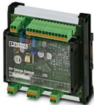
Die Ladesteuerung EV-CC-AC1-M3-CBC-SER-HS-MSTB mit Gehäuse zur Tragschienenmontage und steckbarer Anschlußtechnik dient zum Laden von Elektrofahrzeugen am 3-Phasen-Wechselstromnetz nach IEC 61851-1, Mode 3. Optimiert für Ladestationen mit fest montiertem Fahrzeug-Ladestecker. Alle Ladefunktionen und umfangreiche Konfigurationseinstellungen sind bereits integriert.
