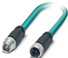
Netzwerkkabel, Ethernet CAT6<sub>A</sub> (10 GBit/s) CAT6<sub>A</sub> (10 GBit/s), 8-polig, PUR halogenfrei, wasserblau RAL 5021, geschirmt (Advanced Shielding Technology), Stecker gerade M12, Kodierung: X / IP67, auf Buchse gerade M12, Kodierung: X / IP67, Kabellänge: 10 m
