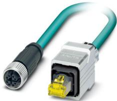
Netzwerkkabel, Ethernet CAT6<sub>A</sub> (10 GBit/s) CAT6<sub>A</sub> (10 GBit/s), 8-polig, PUR halogenfrei, wasserblau RAL 5021, geschirmt (Advanced Shielding Technology), Stecker gerade RJ45 Push-Pull / IP67, auf Buchse gerade M12, Kodierung: X / IP67, Kabellänge: 10 m
