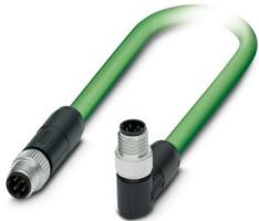
Netzkabel, PROFINET CAT5 (100 MBit/s), EtherCAT® CAT5 (100 MBit/s), 4-polig, PUR halogenfrei, grün RAL 6018, geschirmt (Advanced Shielding Technology), Stecker gerade M8, Kodierung: D / IP67, auf Stecker gewinkelt M8, Kodierung: D / IP67, Kabellänge: 5 m
