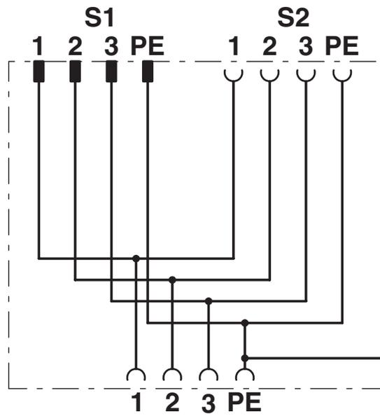
Kontaktbelegung des M12-Y-Verteilers
