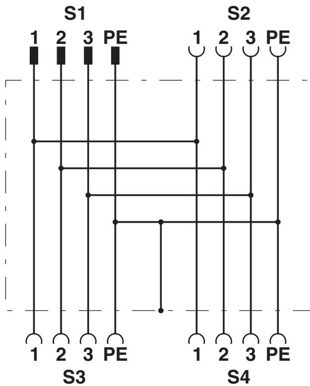
Kontaktbelegung des M12-H-Verteilers
