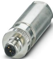
Power-Steckverbinder, Leistung, 5-polig, geschirmt, Stecker gerade M12, Kodierung: K, Push-Lock-Federanschluss, Rändelmaterial: Messing, vernickelt, Leitungsaußendurchmesser 8 mm ... 13 mm
