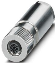
Power-Steckverbinder, Leistung, 3-polig, geschirmt, Buchse gerade M12, Kodierung: S, Push-Lock-Federanschluss, Rändelmaterial: Messing, vernickelt, Leitungsaußendurchmesser 6 mm ...
