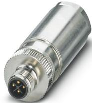
Power-Steckverbinder, Leistung, 4-polig, geschirmt, Stecker gerade M12, Kodierung: S, Push-Lock-Federanschluss, Rändelmaterial: Messing, vernickelt, Leitungsaußendurchmesser 6 mm ... 11 mm, Kontakt 4 voreilend
