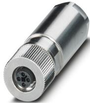
Power-Steckverbinder, Leistung, 4-polig, geschirmt, Buchse gerade M12, Kodierung: T, Push-Lock-Federanschluss, Rändelmaterial: Messing, vernickelt, Leitungsaußendurchmesser 6 mm ...
