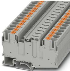
Trennklemme, Strom und Spannung werden durch den eingesetzten Stecker bestimmt., Nennspannung: 500 V, Nennstrom: 20 A, Anschlussart: Push-in-Anschluss, Bemessungsquerschnitt: 10 mm<sup>2</sup>, Querschnitt: 0,5 mm<sup>2</sup> - 16 mm<sup>2</sup>, Montage: NS 35/7,5, NS 35/15, Farbe: grau
