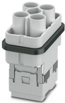
Kontakteinsatz, Polzahl: 4+2+PE, Baugröße: COM, Leistungskontakte: 4, Steuerkontakte: 2, Anzahl der Anschlüsse je Pol: 1, Stift, Crimpanschluss, 400 V, 40 A, 1,5 mm<sup>2</sup> ... 6 mm<sup>2</sup>, Anwendung: Leistung/Signal
