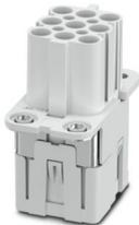
Kontakteinsatz, Polzahl: 8+PE, Baugröße: COM, Leistungskontakte: 8, Steuerkontakte: 0, Anzahl der Anschlüsse je Pol: 1, Buchse, Push-in-Anschluss, 320 V, 16 A, 0,5 mm<sup>2</sup> ... 2,5 mm<sup>2</sup>, Anwendung: Leistung
