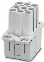
Kontakteinsatz, Polzahl: 8+PE, Baugröße: COM, Leistungskontakte: 8, Steuerkontakte: 0, Anzahl der Anschlüsse je Pol: 1, Buchse, Crimpanschluss, 320 V, 16 A, 0,5 mm<sup>2</sup> ... 4 mm<sup>2</sup>, Anwendung: Leistung
