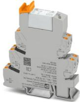
PLC-INTERFACE, bestehend aus Grundklemme PLC-BSC.../21HC/SO46/HI mit Push-in-Anschluss, und steckbaren Miniaturrelais für hohen Dauerstrom, 1 Wechsler, Eingangsnennspannung 230 V AC, mit definierten Ein- und Ausschaltswellen
