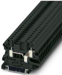
Durchgangsklemme, Nennspannung: 500 V, Nennstrom: 32 A, Anzahl der Anschlüsse: 3, Anschlussart: Schraubanschluss, Bemessungsquerschnitt: 4 mm<sup>2</sup>, Querschnitt: 0,14 mm<sup>2</sup> - 6 mm<sup>2</sup>, Montageart: NS 35/7,5, NS 35/15, Farbe: schwarz
