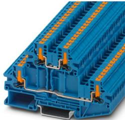
Doppelstockklemme, Nennspannung: 800 V, Nennstrom: 22 A, Anschlussart: Push-in-Anschluss, 1. und 2. Etage, Bemessungsquerschnitt: 2,5 mm<sup>2</sup>, Querschnitt: 0,14 mm<sup>2</sup> - 4 mm<sup>2</sup>, Montageart: NS 35/7,5, NS 35/15, Farbe: blau
